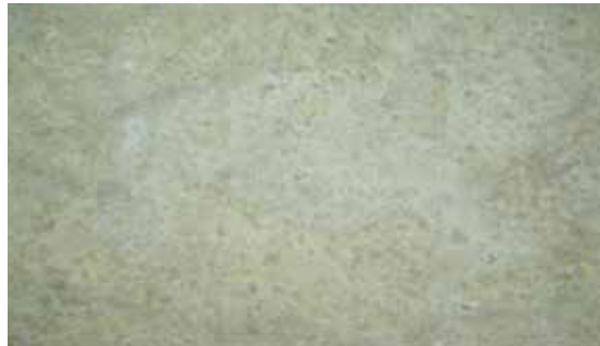
Probeta con DRYMIX RC 4020: SIN RAJADURAS
